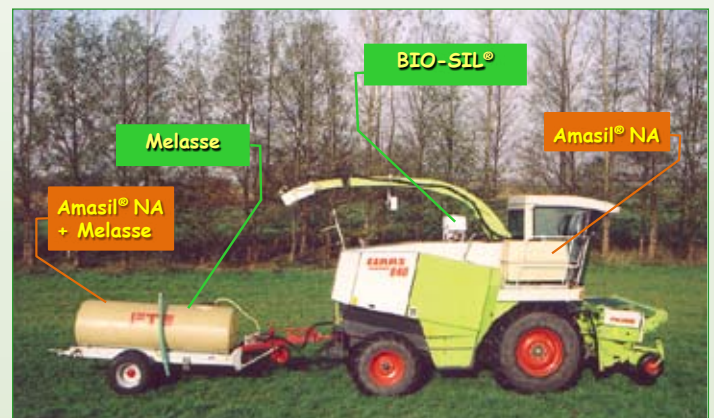
Technische Lösung zur getrennten Applikation von BIO-SIL® und Melasse bzw. Amasil® NA
